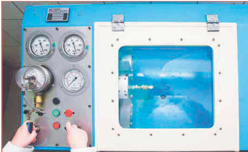
1/2" Hidrolik Otomatik Rekor 1200 Bar basınç altında test edilirken... Test operation of 1/2" Hydraulic Quick Coupling at 1200 Bar...
